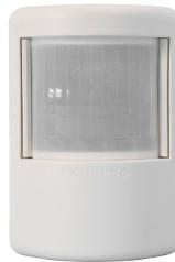
PD-33 DL är en passiv infraröd detektor avsedd för närvarodetektering och stymping av belysningsarmaturer via en DALI-bussledning. Den har en pyro-elektrisk sensor som reagerar på förändringar i värmestrålningen.
