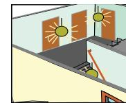
Efter närvärfördräjningen dimras belysningen sakta ner till 10 %. Detektorn stannar med grundljus under inställd tid (1 min - 2 tim, lågnivåfördräjning).
