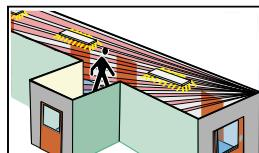
Närvaron i korridoren detekteras av IR-detektorn som håller belysningen tänd.
