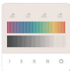
RGB slider, dim slider, 4 grupper, 4 scener, av/på. Standard: 24035410-G07A Med PS 70mA: 24035410-PS-G07A
